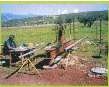
נסיונות שליפת כלונסאות עם שרוול ע"י מעבדת הטכניון
